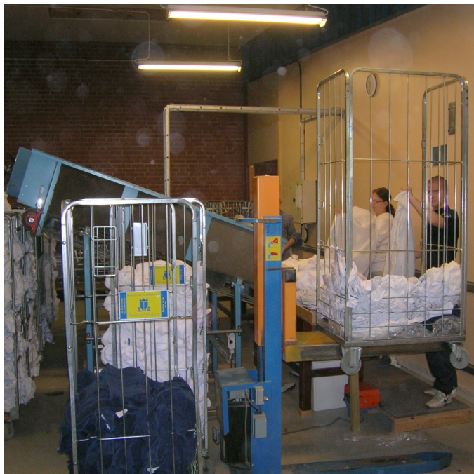
Bild 2. Sortering vid en av de mindre maskinerna, "räknebandet". Bandet används för att kontrollera exakt hur många plagg av olika sorter som kommit från ett visst företag så att samma mängd ren tvätt går tillbaka till det företaget.
